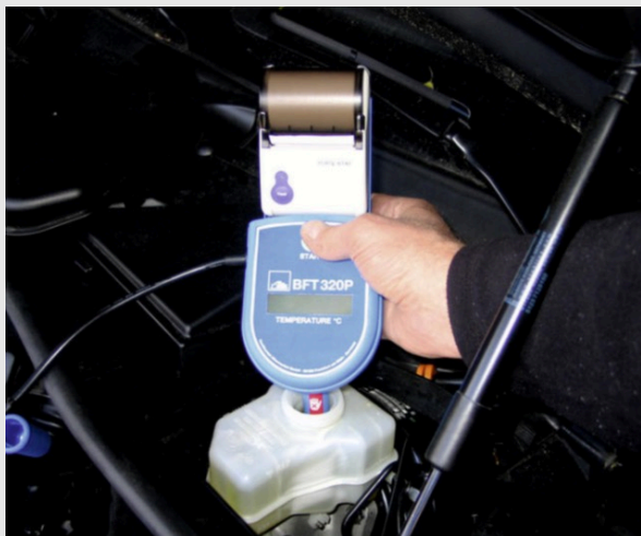
Тест на содержание воды в тормозной жидкости
